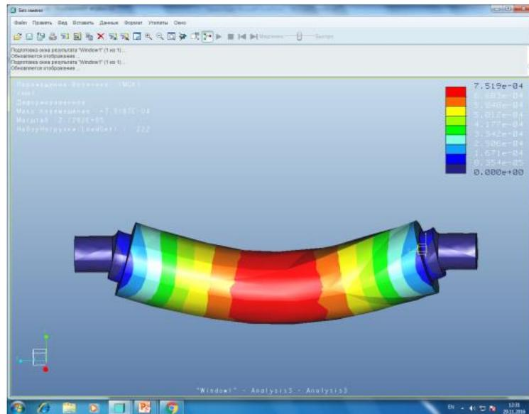
Инженерный расчет по определению минимально возможной толщины рубашки трубчатого вала, выполненный в системе автоматизации математических расчетов MathCad, для последующего 3D-моделирования
